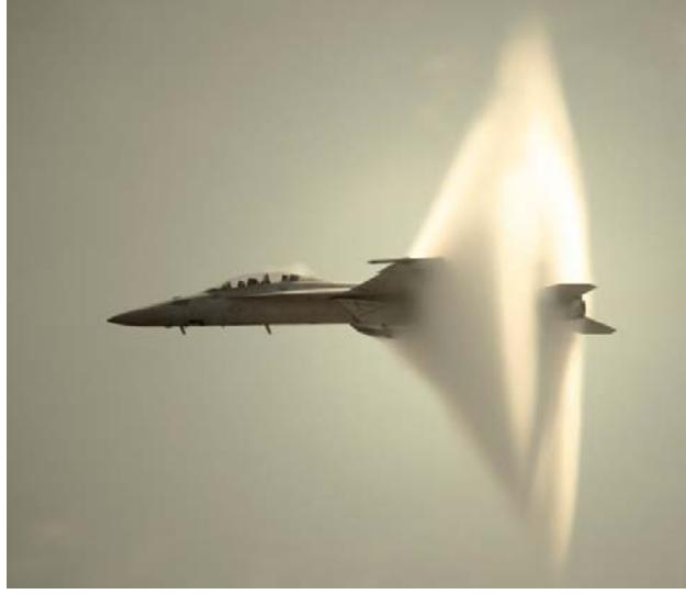
Nous allons montrer qu'une onde de choc ne peut pas créer des nuages de condensation, que ces derniers résultent d'une détente isentrope (même en subsonique), et que leur forme conique est associée à l'angle d'une onde de Mach en écoulement supersonique.
